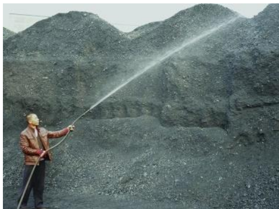
洒水降尘实例照片
